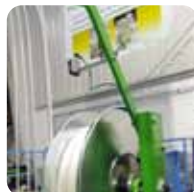
Avisador final bobina Warning of end of reel Signale fin bobine feuillard
